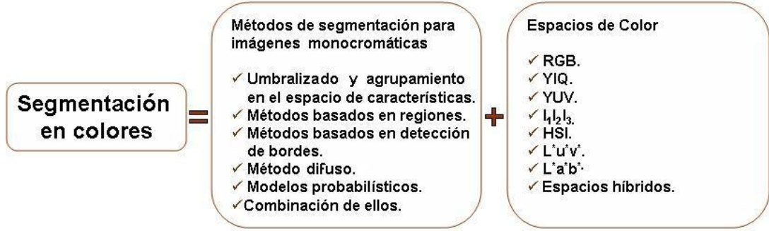
Figura 2.5. Métodos de segmentación en colores comúnmente usados.
