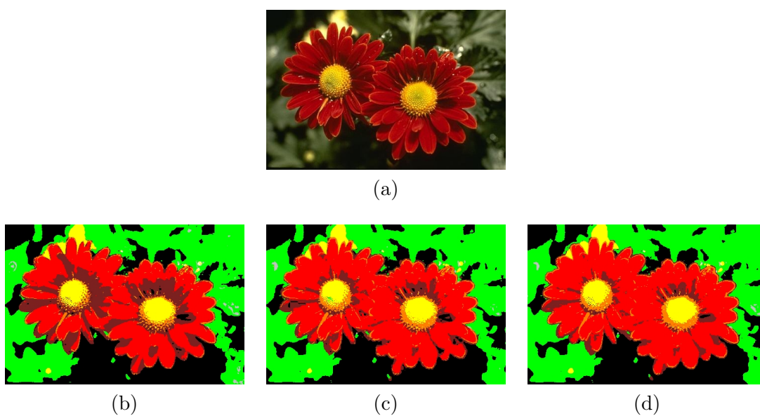
Figura 4.22. (a) Imagen original, segmentación usando la partición en (b) espacio RGB, (c) espacio L^*u^*v^* , (d) espacio L^*a^*b^* .
