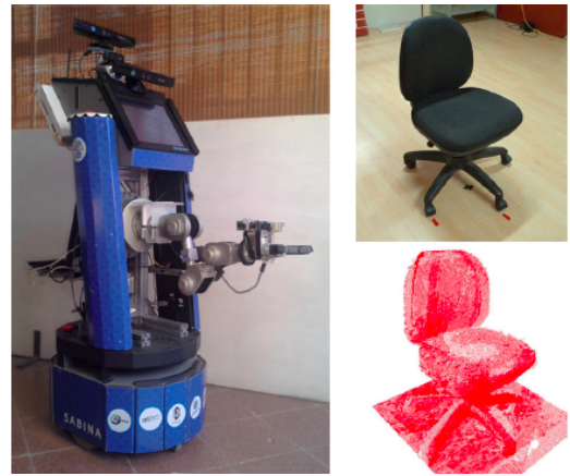
(b) Reconstrucción de objetos, un manipulador móvil equipado con un sensor 3D se utiliza para reconstruir objetos de manera autónoma, en la imagen el objeto reconstruido es una silla. Imagen tomada de [14]
