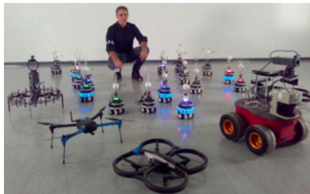
Figura 5: Un conjunto de robots heterogéneos, algunos de ellos terrestres otros aéreos, que pueden cooperar para realizar tareas, por ejemplo inspeccionar un campo de cultivo, o explorar un ambiente y construir un mapa de dicho ambiente.
