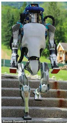
(a) Robot humanoide Atlas, diseñado y construido por Boston Dynamics.
