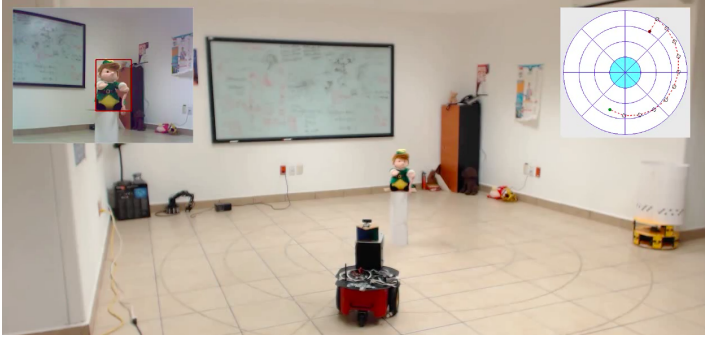
(a) Búsqueda de objetos, el robot está equipado con una cámara para tomar imágenes del objeto a detectar y un teledetector láser para medir distancia a los obstáculos y evitar colisionar con ellos. Imagen tomada de [13]
