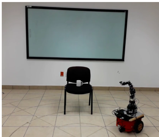
Figura 7: Un robot manipulador móvil equipado con una cámara en el efector final del brazo, es capaz de mantener un objeto estático (en este experimento una taza sobre una silla) en el campo de vista de la cámara, mientras el robot se mueve de una posición a otra, viajando las trayectorias más cortas en tiempo en un ambiente con obstáculos. Imagen tomada de [16].
