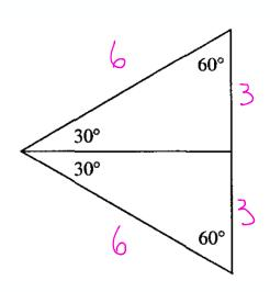
Recuerda que los A's rectargulos con un ángulo de 30° se obtienen como la mitad" de un \( \text{ equilátero.} \)
